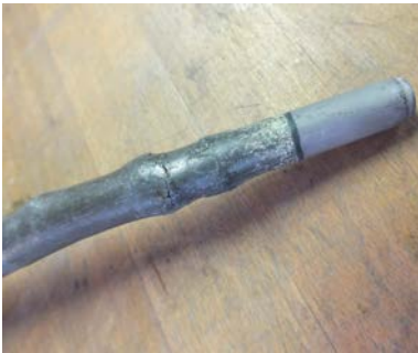
Corrosie van een loden orgelpijp (bron: Flentrop)
