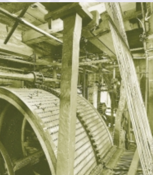
Waag van Alkmaar. Speeltrommel van Willem Sprakel uit 1687
