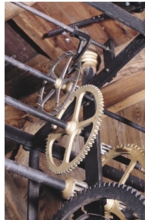
Hervormde kerk van Benningbroek, Noord-Holland. Gerestaureerd uurwerk met pennengang van A. Vos uit 1864
