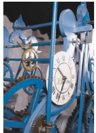
Hervormde kerk van Dirksborn. Goed zichtbaar is de hakengang. Gietijzeren uurwerk van A. Batstra uit 1869
