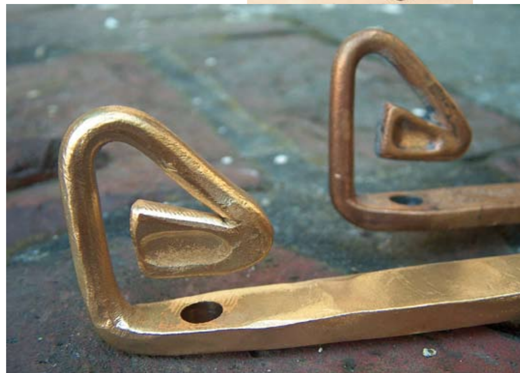
Verloren gegaan hang- en sluitwerk is soms niet meer te koop, maar soms wel na te maken. Op de voorgrond de kopie, op de achtergrond het origineel van De Vries Robbé & Co. Vergelijk met de tekening hierboven en met die op pagina 3
