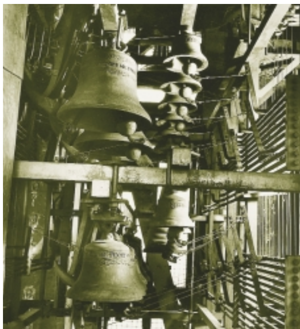
Tractuur met een tuimelaarsysteem in de vieringtoren van de Grote kerk te Haarlem (foto 1970)
